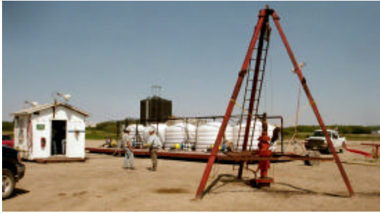
Herstellung und Injektion von gipsbildenden Lösungen bei Mosaic Potash Esterhazy Ltd. (Canada)
