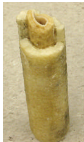
Durch Einsatz einer \text{CaSO}_4 -übersättigten Lösung gewachsene Gipskrusten
